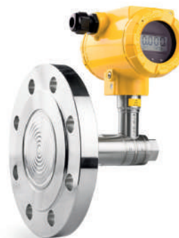
Modelo: APRE-2000 Transmisor de presión con conexión bridada para medición de nivel al tanque, ensamblado de fábrica. Señal de salida: 4-20mA + protocolo HART.
