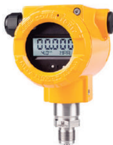
Modelo: APC-2000 (disponible con display), Rango: -1 a 1000 bar (100 MPa). Salida: 4-20mA. Conexión: NPT (1/2", 1/4").
