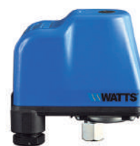
Modelo: PA5; PA12 Para bombas y autoclaves. Rangos: 1...12bar. Conexión: G1/4". Temp. máx del fluido: 90°C.
