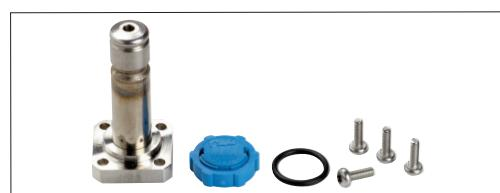
Evita la acumulación de contaminantes que pueden impedir el movimiento del inducido. Permite el uso de medios más agresivos que, en condiciones normales, atacarían el inducido. Su relleno de gel garantiza su correcto funcionamiento tras períodos prolongados de inactividad. Este kit se puede usar para tamaños de orificio hasta DN 4.5.
