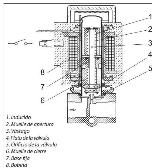
**Bobina con tensión desconectada (válvula cerrada):**
