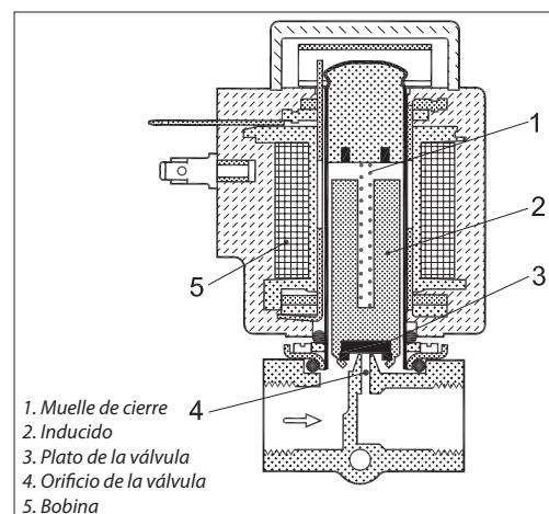
**Bobina con tensión conectada (válvula abierta):**
