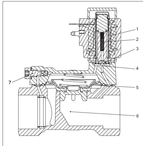
**Bobina con tensión desconectada (válvula cerrada):**
