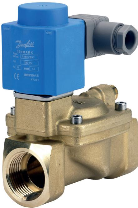
EV224B para aire comprimido, válvula servoaccionada 2/2, para alta presión, hasta 40 bar; temperatura del medio hasta 60 °C, y disponible en las versiones NC y NO. Gracias al filtro piloto integrado de serie, el orificio de compensación intercambiable y las carcasa con grado de protección máximo IP67 (según la bobina), esta válvula garantiza un funcionamiento fiable y satisfactorio.
